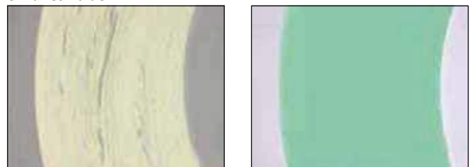
Ilustración 3.4 Observación estereomicroscópica de secciones de tubo con una mala dispersión del pigmento y aditivos
