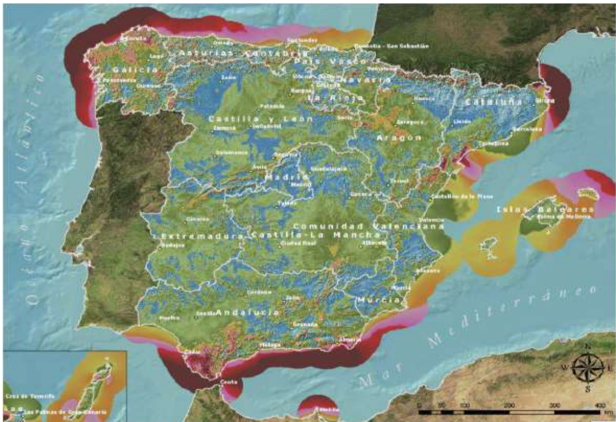
Figura 6. Potencial eólico medido a una altura de 80 metros
