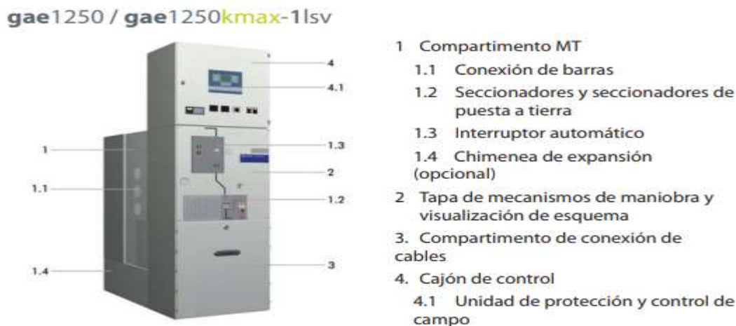
Figura 36. Estructura constructiva y componentes de celdas Ormazabal gae1250kmax-1lsv [12]
