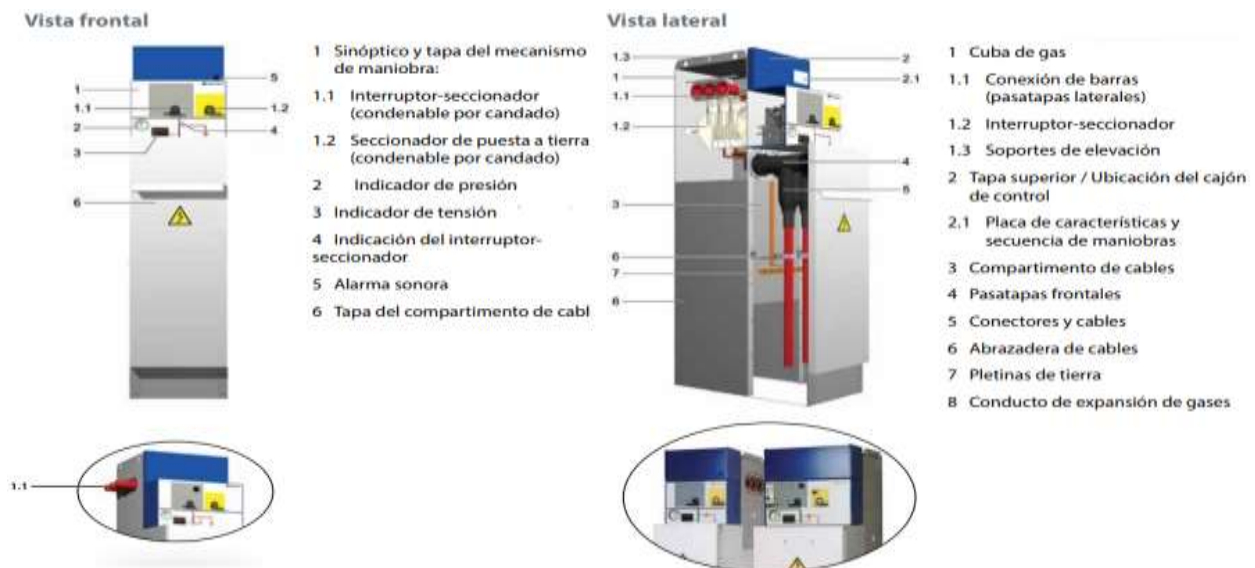
Figura 35. Estructura constructiva y componentes de celdas Ormazabal cgmcosmos [12]
