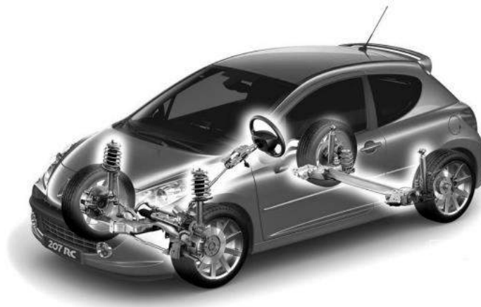
Figura 2- 1: Sistema de Suspensión Peugeot 207. [3]
