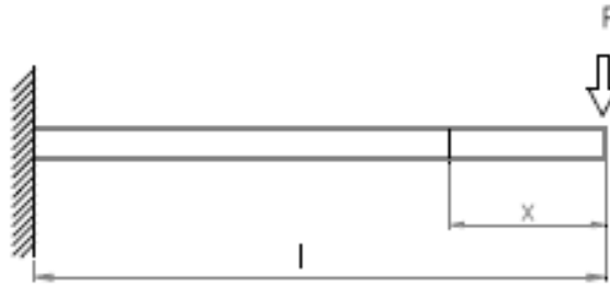
Figura 4- 2: Viga empotrada en un extremo
