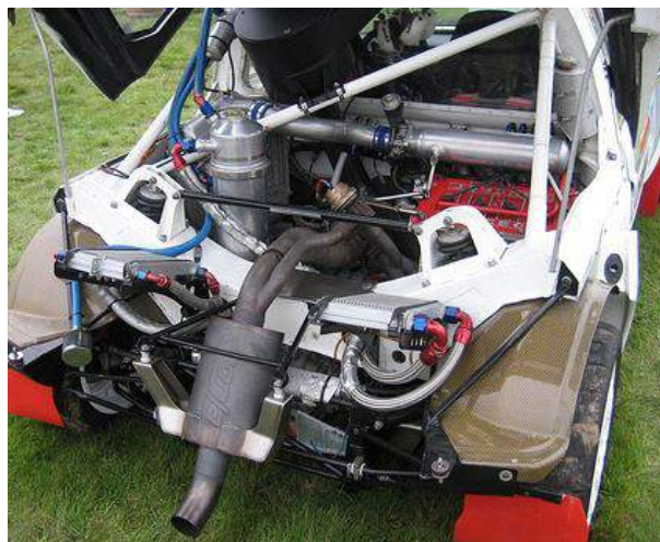
ILUSTRACIÓN 3. MOTOR 1.775cc 4 CILINDROS EN LÍNEA TURBOALIMENTADO DE 500 CV Y POSICIÓN CENTRAL QUE MONTABA EL PEUGEOT 205 T16.
