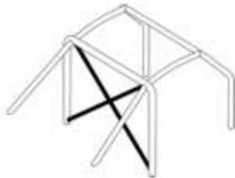
ILUSTRACIÓN 26. EN NEGRO SE OBSERVAN LOS 2 TIRANTES DIAGONALES.
