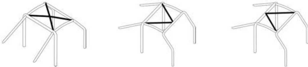
ILUSTRACIÓN 28. REPRESENTACIÓN GRÁFICA DE LAS TRES CONFIGURACIONES PERMITIDAS PARA EL REFUERZO DE LA PARTE SUPERIOR DE LA ESTRUCTURA DE SEGURIDAD.
