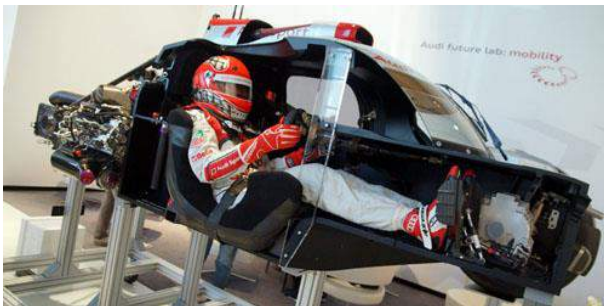
ILUSTRACIÓN 16. COCKPIT DE FIBRA DE CARBONO Y KEVLAR DEL AUDI R18 E-TRON QUATTRO (LMP1).
