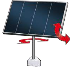
Ilustración 17. Sistema de seguimiento solar en dos ejes.
