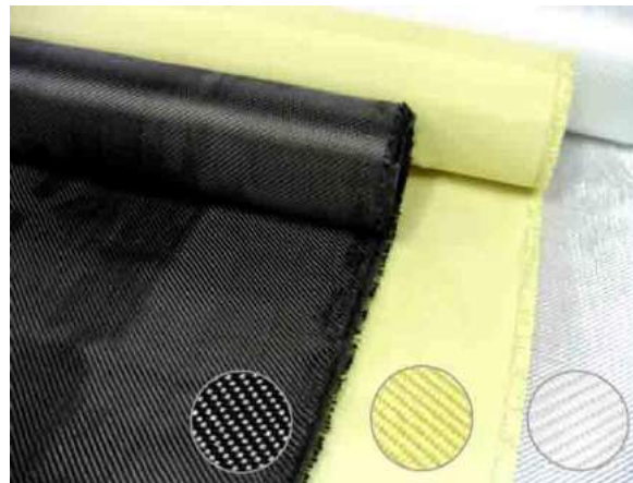
Figura 1.7.- De izquierda a derecha: fibra de carbono, fibra de aramida y fibra de vidrio [9].
