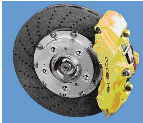
Figura 1.3.- Freno de disco constituido por materiales compuestos cerámicos [5].
