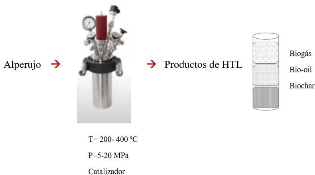
Figura 11. Esquema proceso producción de bio-oil a partir de alperujo. Elaboración propia.
