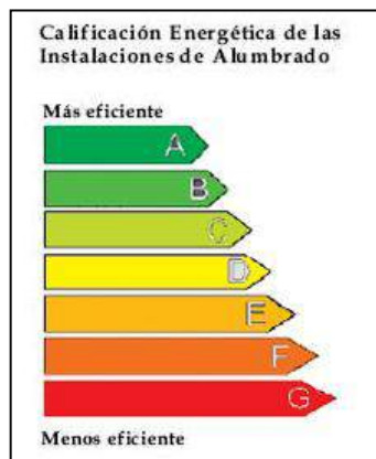
Figura 5.7 Calificación energética de las instalaciones de alumbrado
