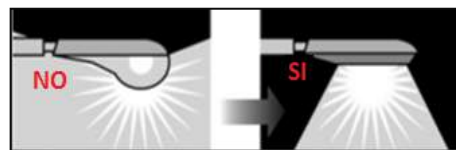
Figura 3.2 Recomendación para un buen diseño de luminaria vial
