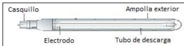
Figura 3.11 Partes de una lámpara de vapor de sodio a baja presión
