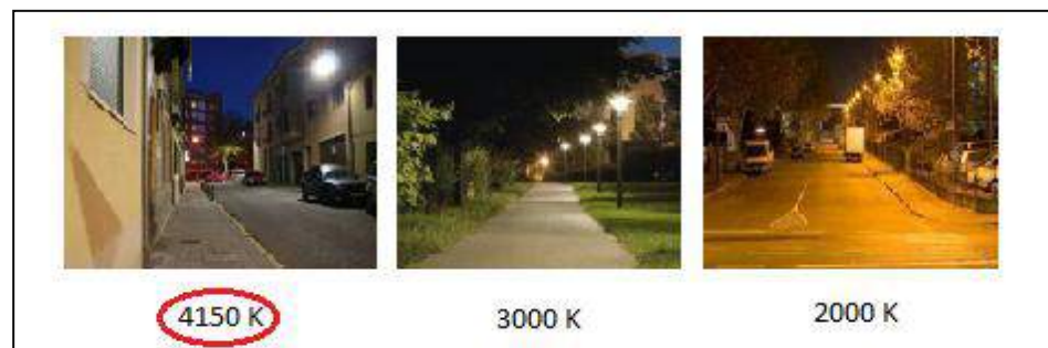
Figura 5.2 Vías iluminadas con fuentes de luz de distintas temperaturas de color T_c
