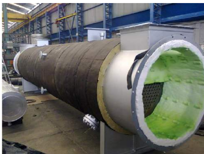
Figura 20: Aislamiento de calderas, Zitró aislamientos termoacústicos
