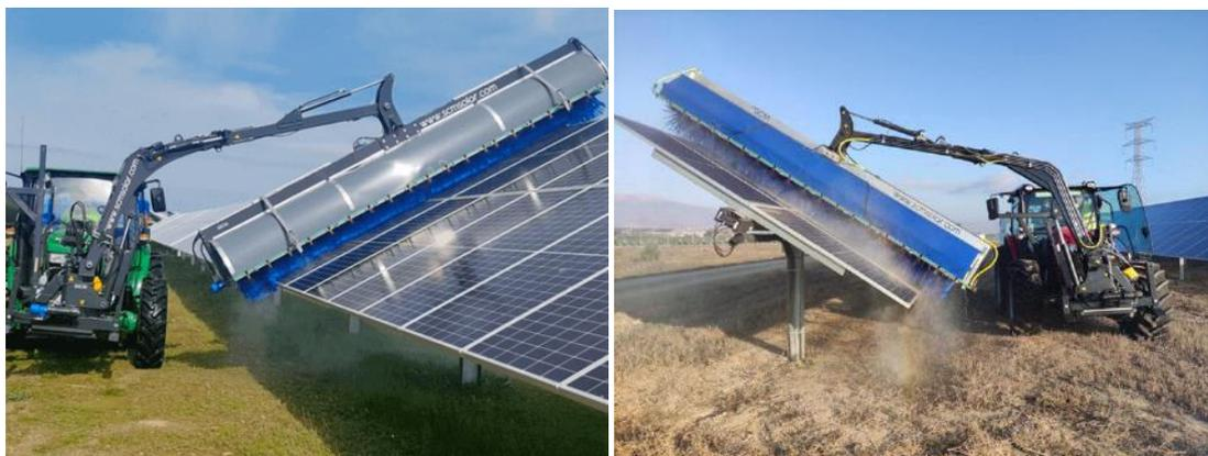
Figura 4-1. Sistema de limpieza montado en vehículo. Modelo D2 [45]
