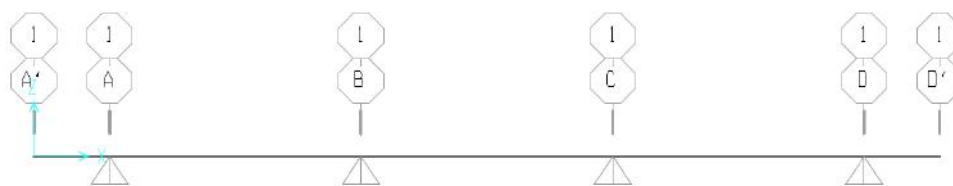
Figura 6-3. Modelo de barra simplemente apoyada con voladizo y misma luz.
