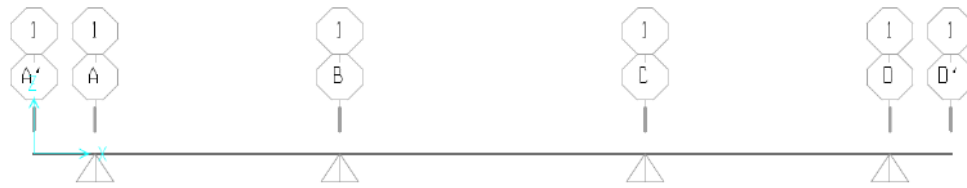
Figura 6-7. Modelo de barra simplemente apoyada con voladizo y luz variable.
