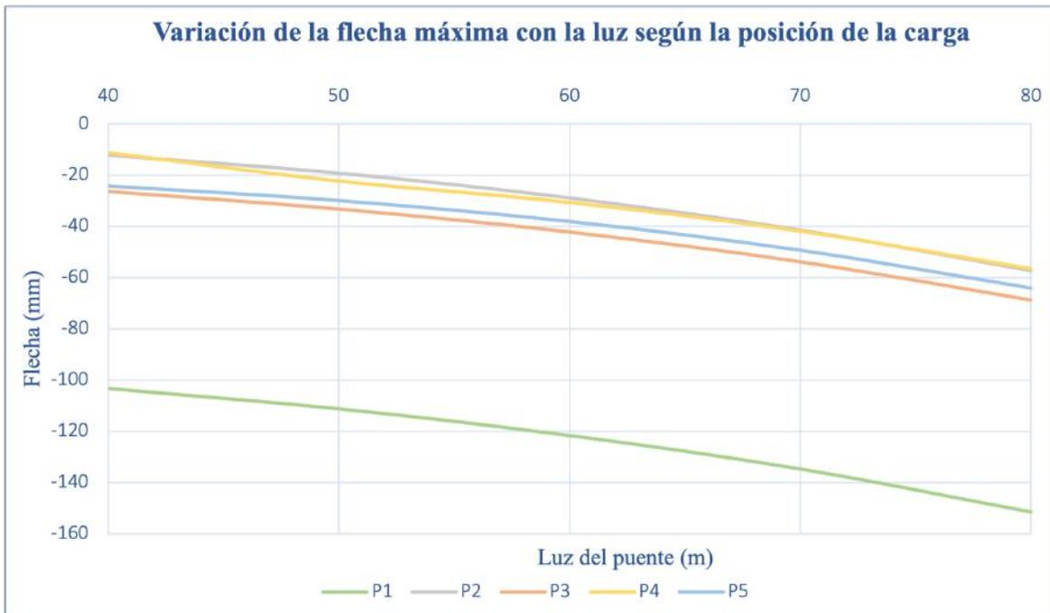
Figura 45. Desplazamientos máximos al variar la luz del puente y la posición de la carga.
