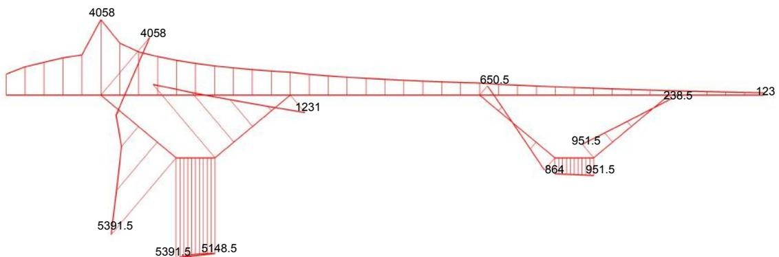
Figura 126. Distribución de (KPa) en la sección x=20 m para P2, del modelo de 40° de inclinación
