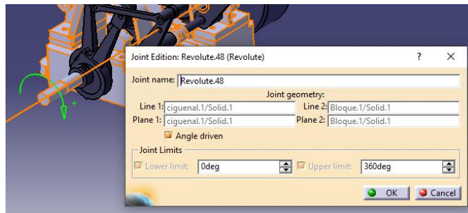
Figura 4.34 Revolute entre cigüeñal y bloque fijo.
