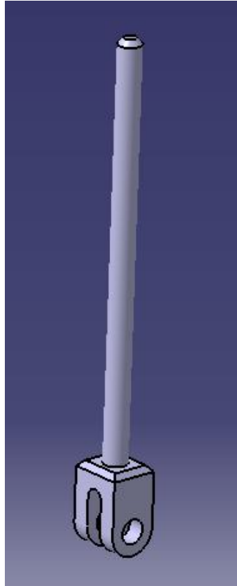
Figura 3.38 Barra de distribución.
