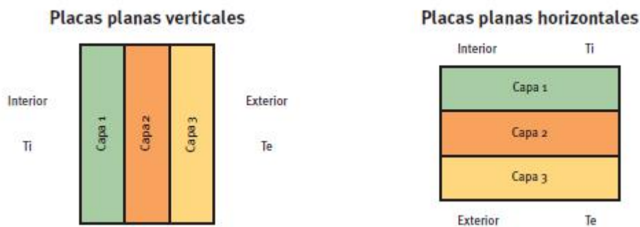
Ilustración 7. Transmisión de calor en una superficie con 3 materiales distintos.[6]
