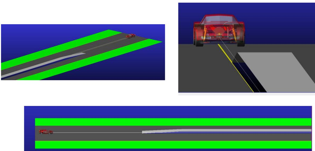
Ilustración 47: Maniobra Straight Line Maintain con rampa
