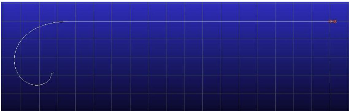
Ilustración 41: Maniobra Line change a 50 Km/h y Max steer value 270
