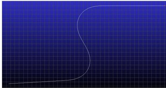
Ilustración 38: Maniobra Line change a 50 Km/h y Max steer value 90
