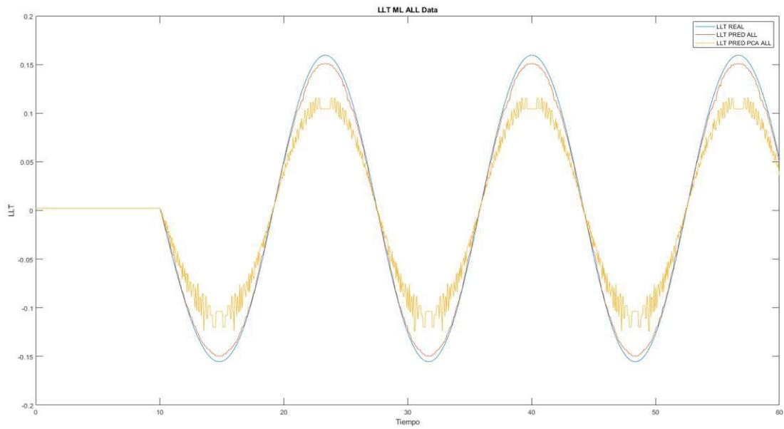
Ilustración 56: Comparativa para 16 datos de entrada con Machine Learning con la maniobra eslon
