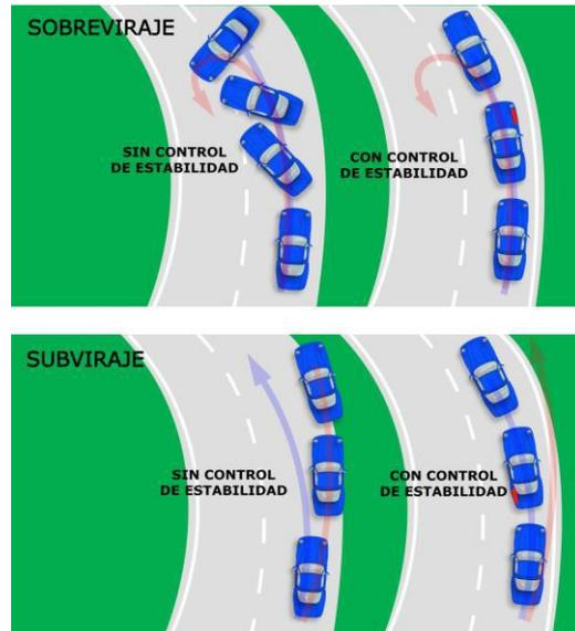
Ilustración 23 : Sistema ESP
