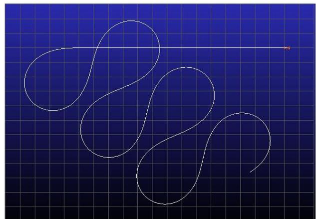
Ilustración 53 Maniobra eslalon a 50 Km/h y Max steer value 180 y 225 respectivamente
