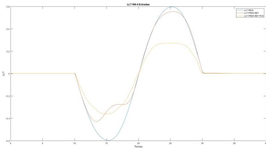
Ilustración 45: Comparativa para 4 datos de entrada con NN con la maniobra single lane change
