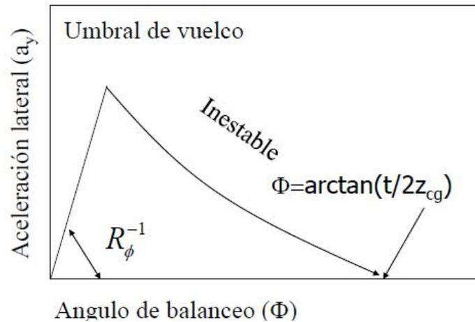
Ilustración 3 : Umbral de vuelco vehículos con suspensión.
