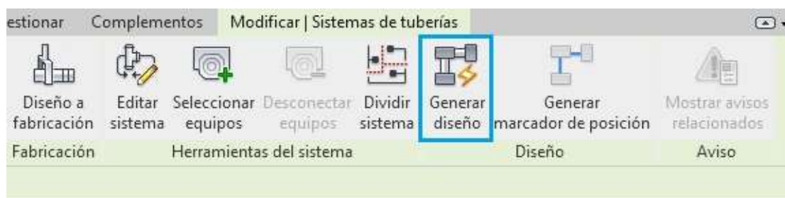
Figura 6.13. Herramienta generación de diseño de tuberías automático
