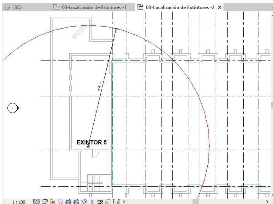
Figura 8.12. Anotaciones para comprobación radio de acción extintores (2)
