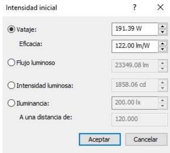
Figura 7.36. Configuración intensidad inicial luminarias
