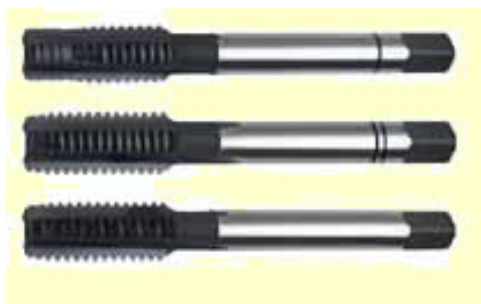
Fig.15. Juego de tres machos y utilización de cada uno.
