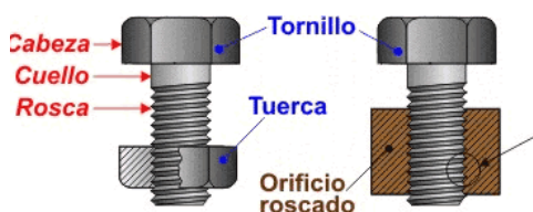
Fig. 2. Rosca exterior (TORNILLO) y rosca interior (TUERCA)
