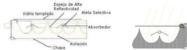
Figura 1.22 Esquema de un colector parabólico (izqda.). Marcha de Rayos (dcha). Fuente: [17].
