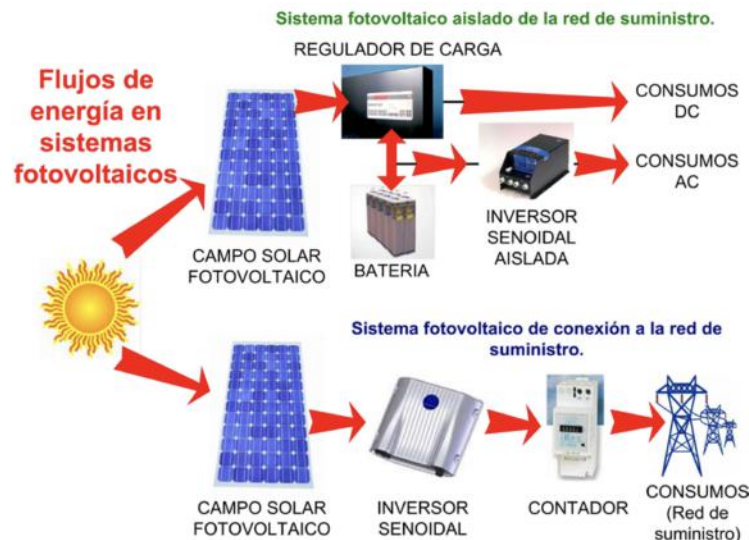
Figura 1.9 Sistemas fotovoltaicos aislados (superior) y de conexión a red (inferior) con los diversos elementos que forman parte de una instalación típica. Fuente: [40].
