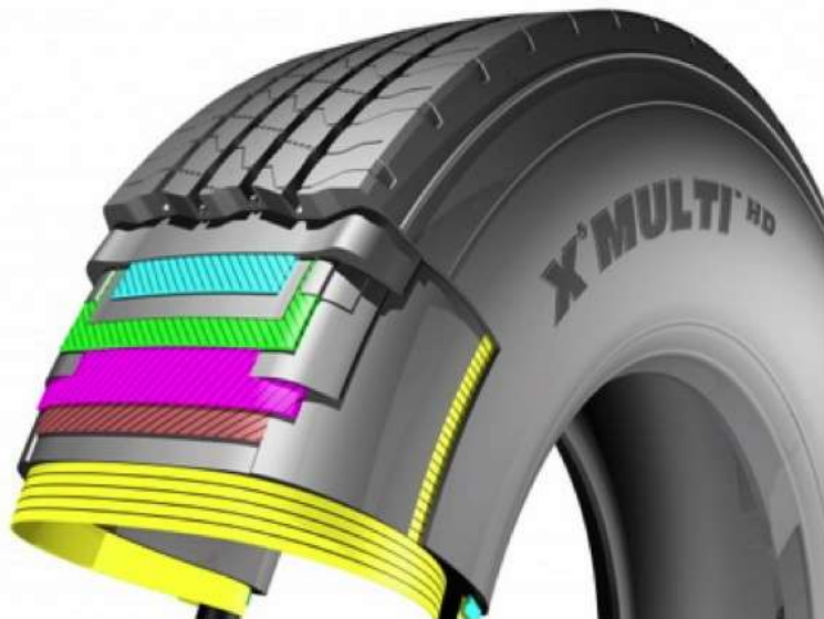
Figura 2.9. Componentes estructurales de un neumático.
