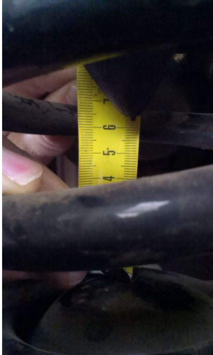
Figura 3.3. Medida del muelle delantero.
