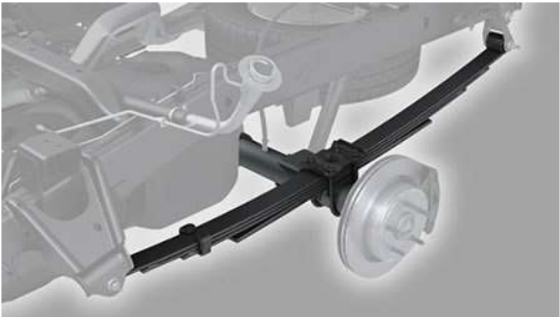
Figura 2.5. Ballesta anclada a eje rígido.
