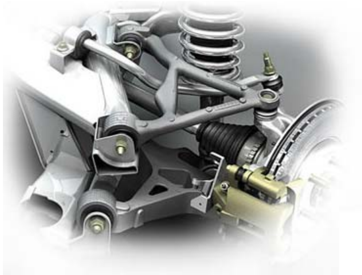
Figura 3.26. Detalle de suspensión de paralelogramo deformable
