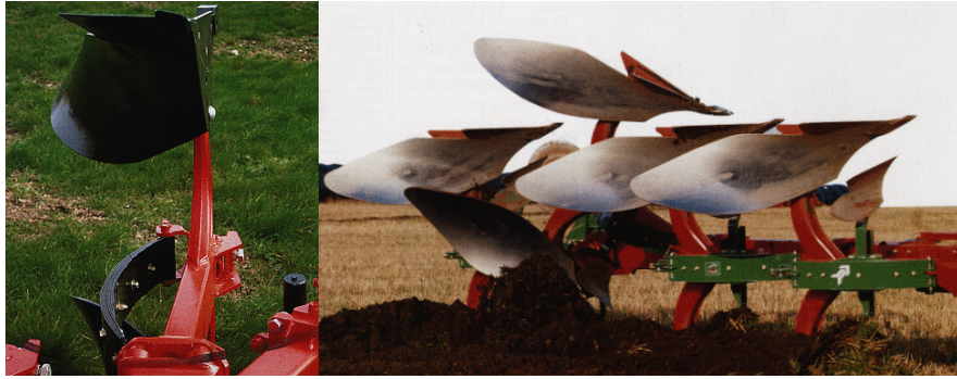
Figura 3.14.- Detalle de vertederas cortas y largas.
