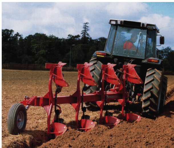
Figura 3.1.- Detalle de laboreo con arado de vertedera.
