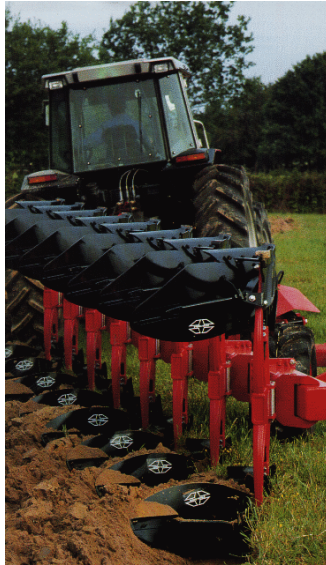
Figura 3.16.- Tractor con arado heptasurco reversible de vertedera helicoidal.
