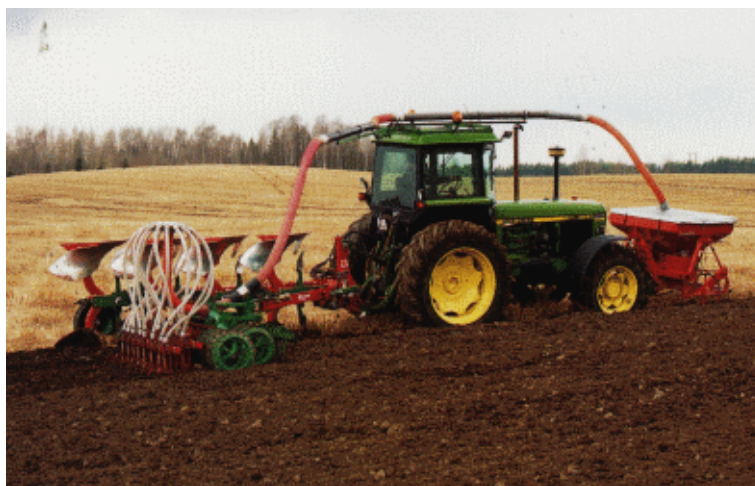
Figura 3.8.- Tractor con aperos múltiples para evitar degradación.
