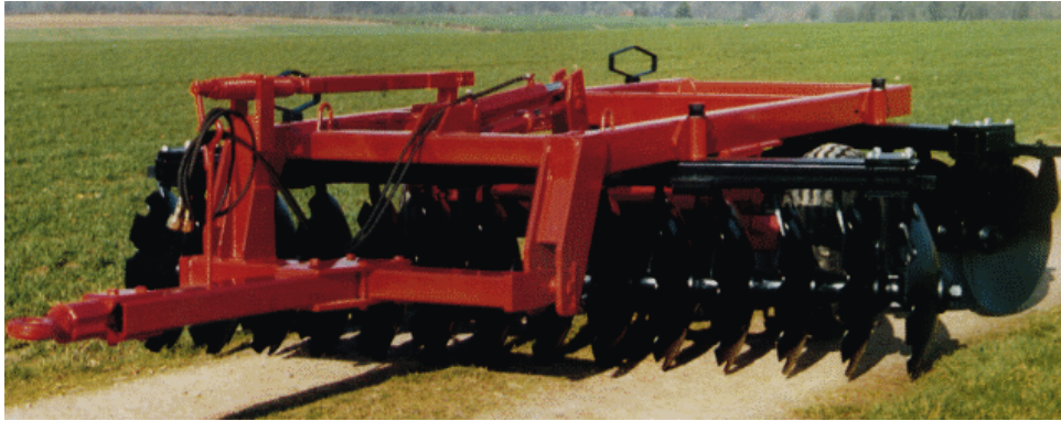
Figura 3.26.- Gradas de discos semisuspendida al tractor.
