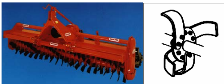
Figura 3.22.- Fresadora con láminas acodadas curvadas y detalle.
