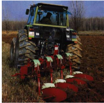
Figura 3.18.- Tractor con arado tetrasurco con seguridad de ballesta.
