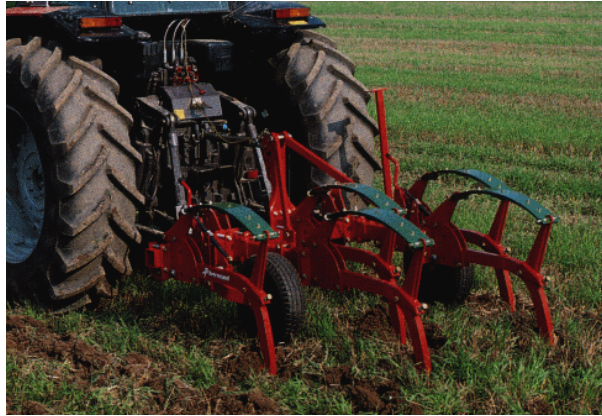
Figura 3.31.- Chisel con seguridad de ballesta.
