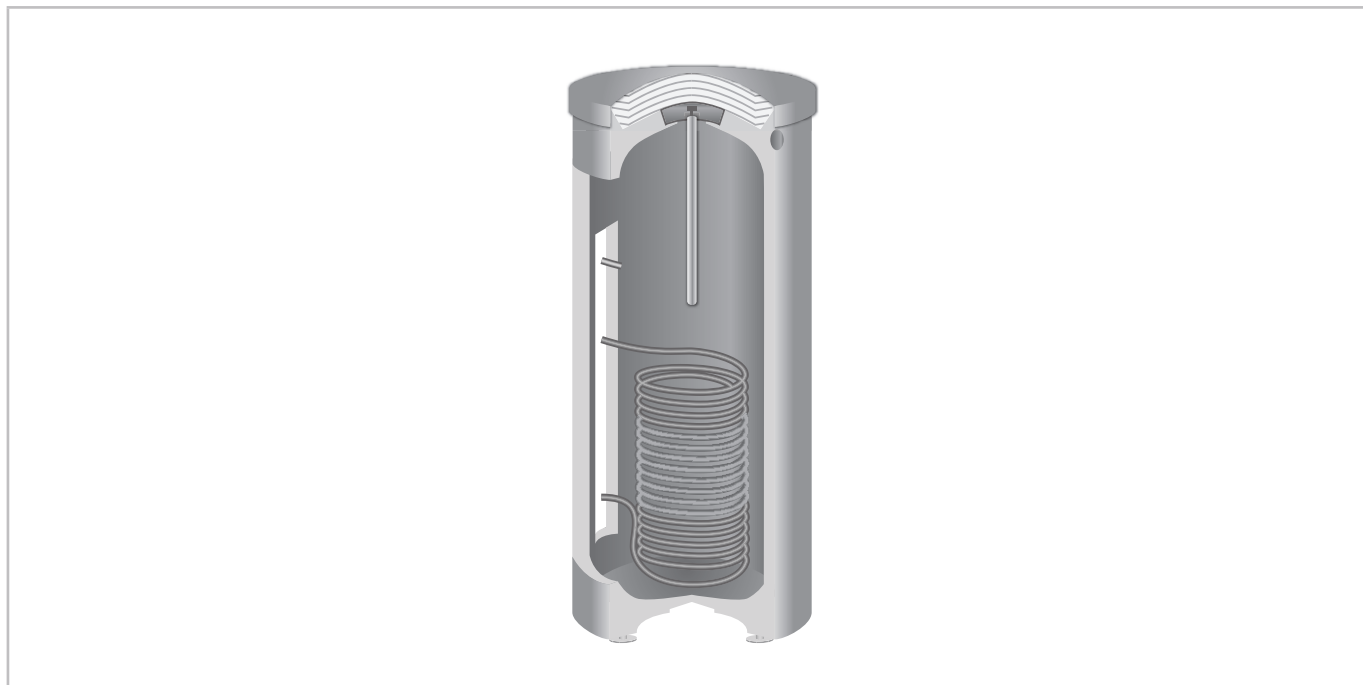
FIGURA 3-16 ACUMULADORES CON INTERCAMBIADOR DE SERPENTÍN Y DE DOBLE ENVOLVENTE
